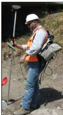
Figura 1-1– Strumentazione utilizzata per la georeferenziazione dei punti di sondaggio
